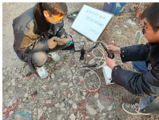
8#地下水采样点位洗井
